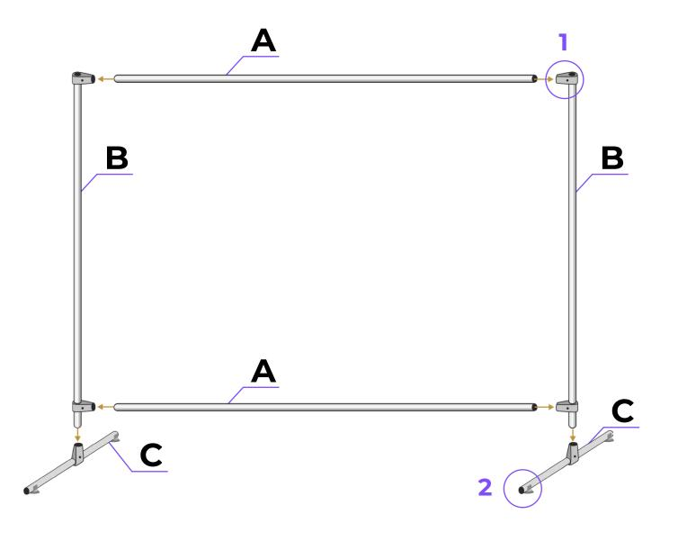
**А** труба **d25 мм** — верх и низ конструкции
